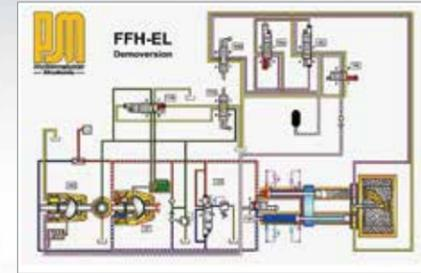
▲切替シリンダーは、アキュムレーターで瞬時に(0.15秒)切り換えて、吐出圧力の変動を最小限に留め、コンクリートをほぼ連続で圧送することを可能にしています。
